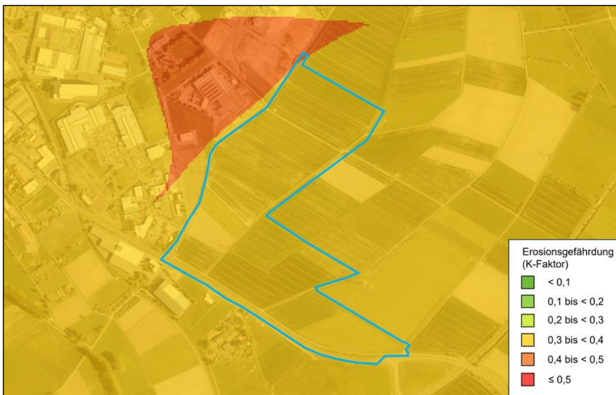
Abb. 3: Bodenerodierbarkeit gemäß K-Faktor; Plangebiet: blau umrandet, (Quelle: BodenViewer Hessen, abgerufen am 13.03.2024, eigene Bearbeitung)
