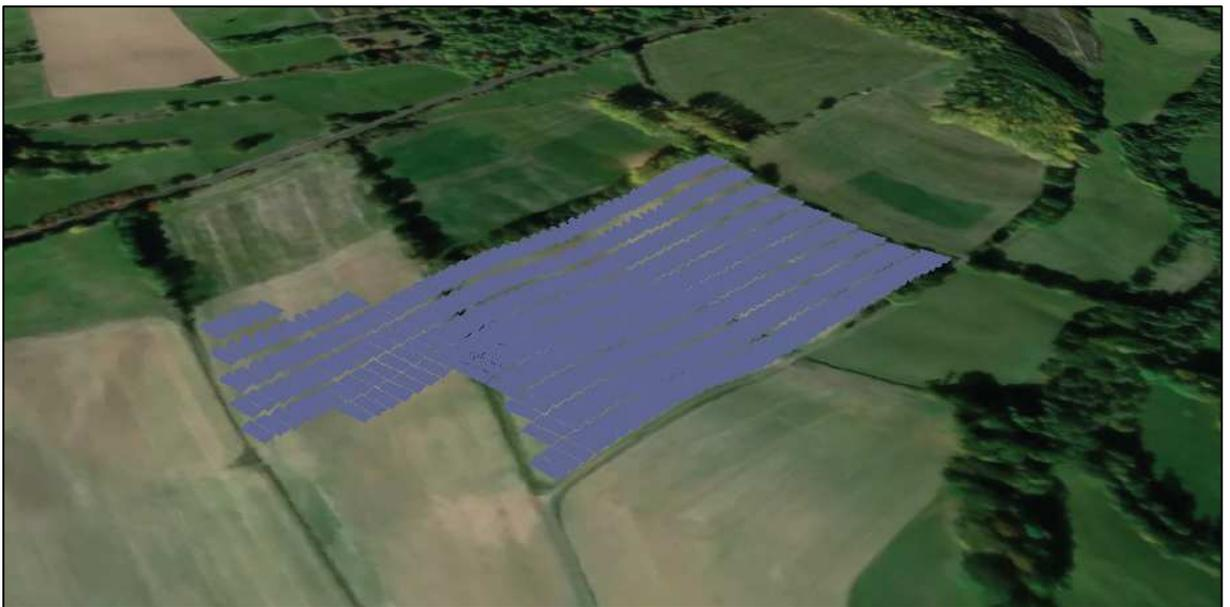
Die Modultische werden auf Metallpfosten aufgeständert, die fundamentlos in den unbefestigten Untergrund gerammt werden. Der lichte Abstand zwischen den Modultischreihen beträgt zwischen 3,5 und 4,5 m. Der Abstand der Unterkante der geneigten Modulfläche liegt bei mindestens 0,8 m über dem natürlichen Gelände. Die Oberkante der Modulfläche liegt auf einer Höhe von maximal 3,5 m über Gelände, abhängig vom Geländeverlauf.
