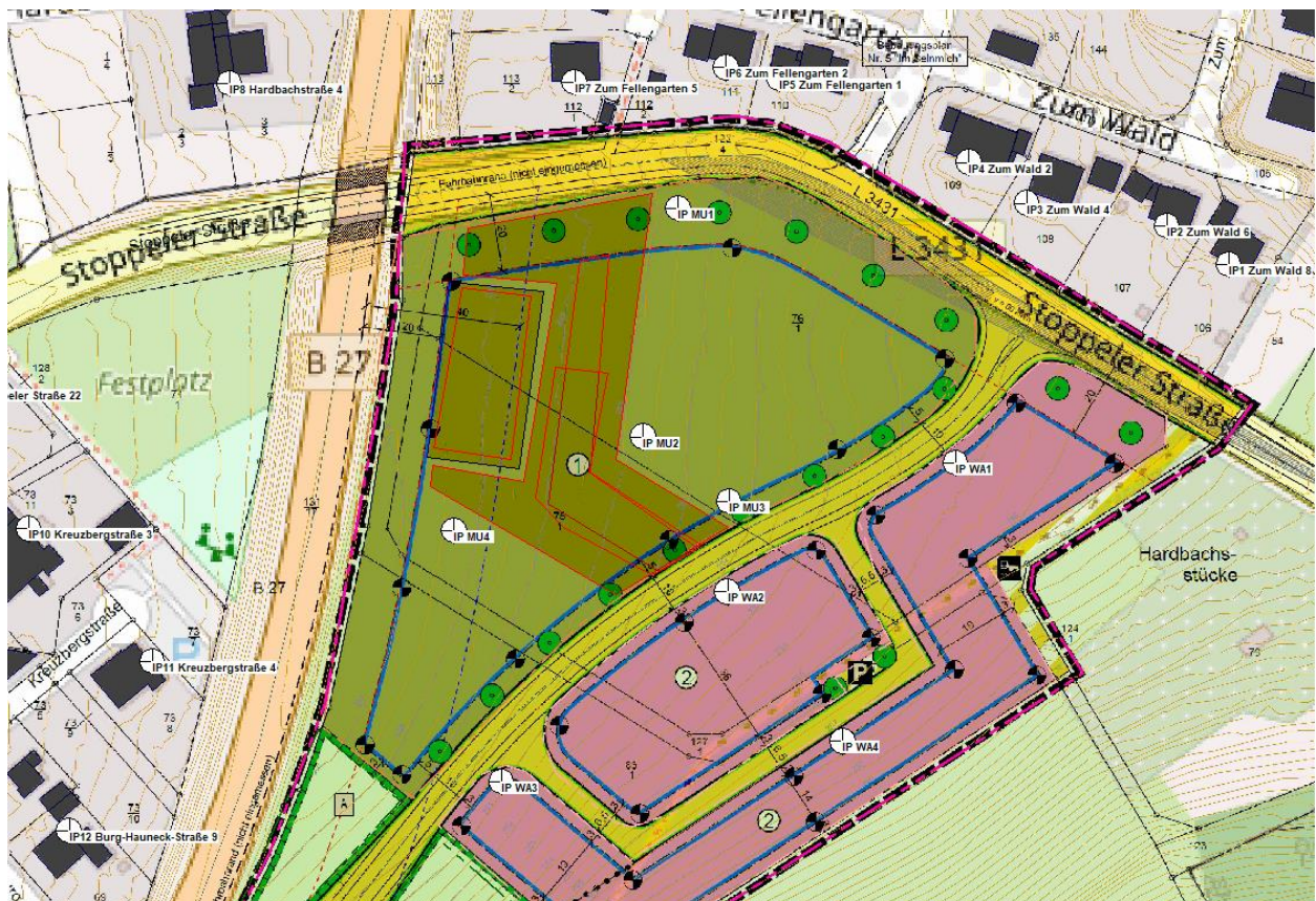
Abb. 3: Auszug aus dem Berechnungsmodell mit Kennzeichnung der Immissionsorte Feuerwehr
