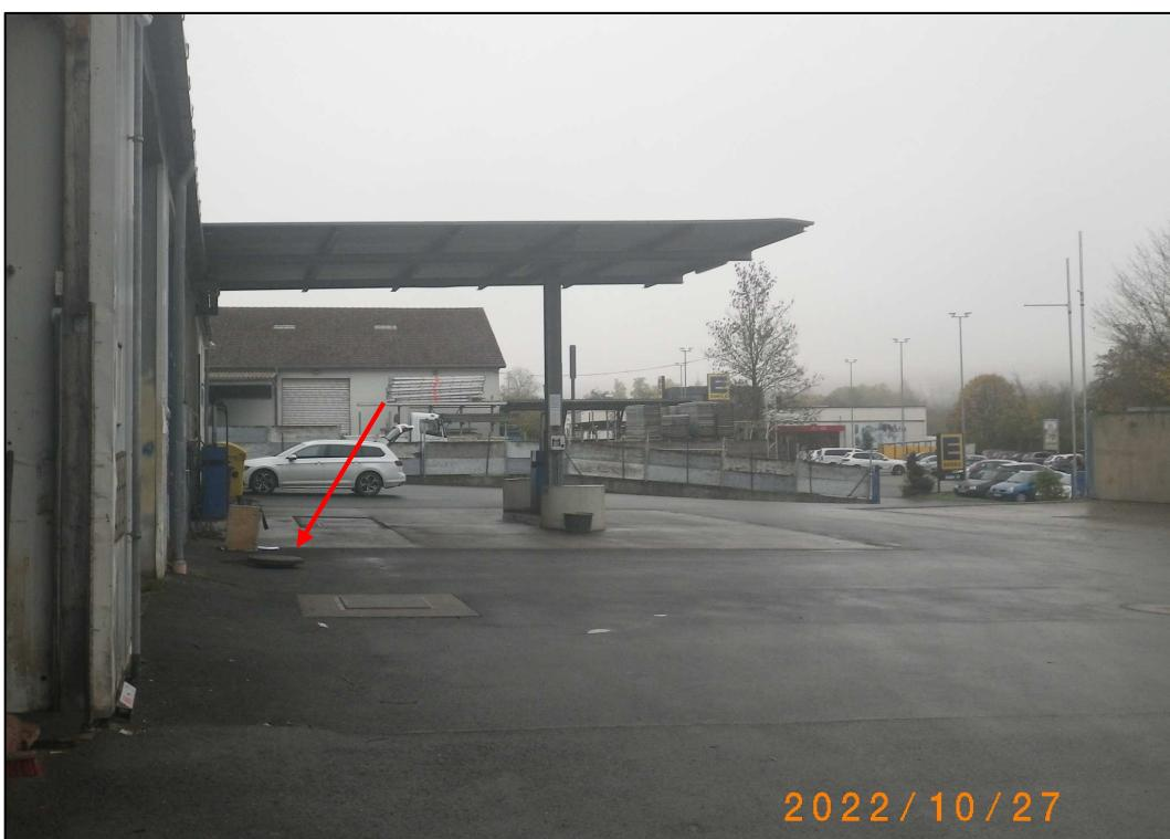
Dazu wurde am 27.10.2022 aus dem 4,64 m tiefen Brunnen/Schacht (vgl. Anlage 2 und Foto) das Grundwasser mit einer Saugpumpe beprobt. Der Wasserstand im Schacht lag bei nur 3 cm. Nach dem Abpumpen von etwa 0,7 ltr Wasser war der Schacht leergepumpt. Innerhalb von einer Stunde wurde kein messbarer Wasserzulauf registriert.
