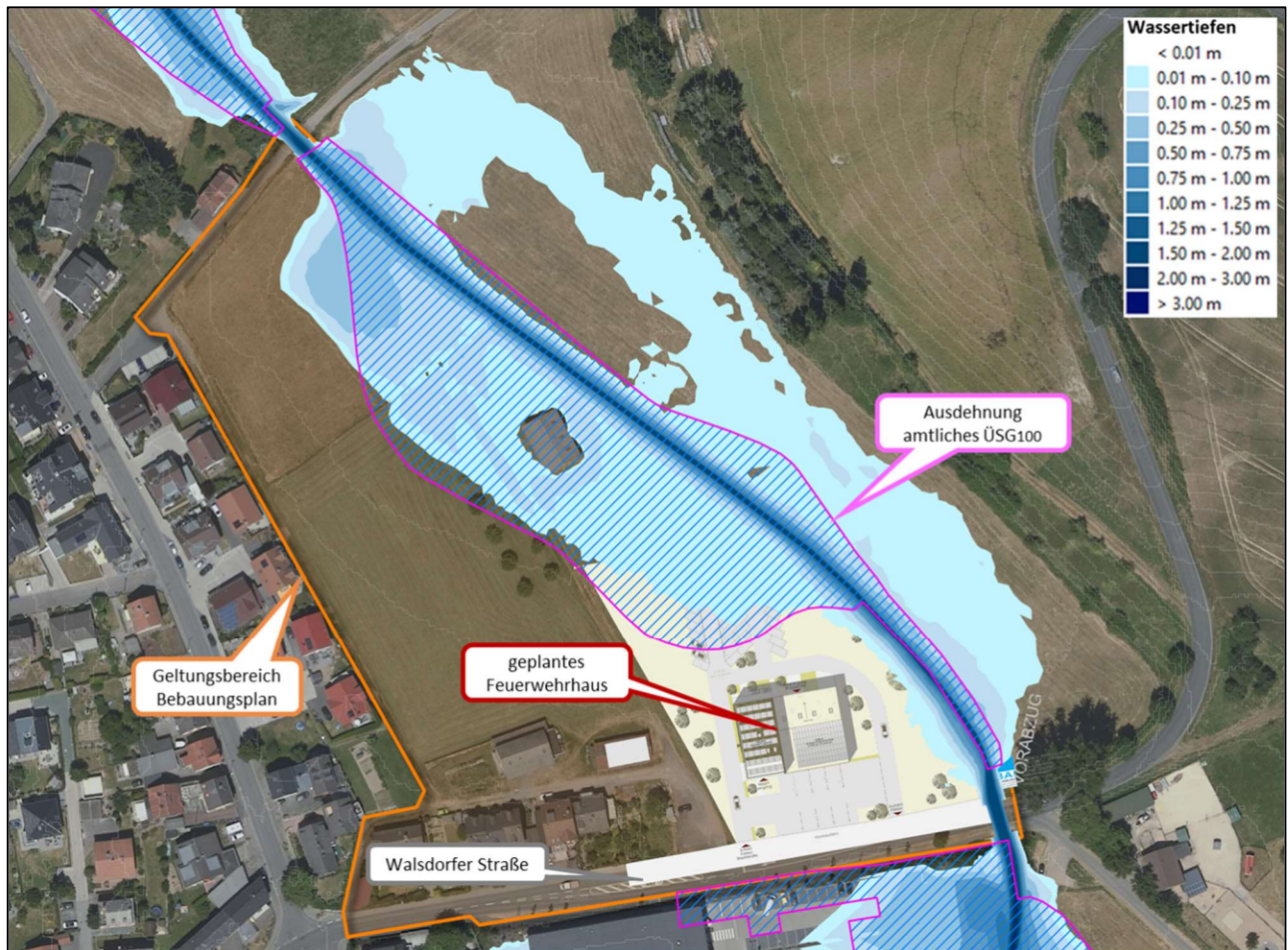
Abbildung 6: In Höhe des Vorhabensbereichs berechnete 100-jährliche Wassertiefen (Ist-Zustand) mit amtlichem ÜSG 100 , Hintergrund: DOP20 (/U5/)
