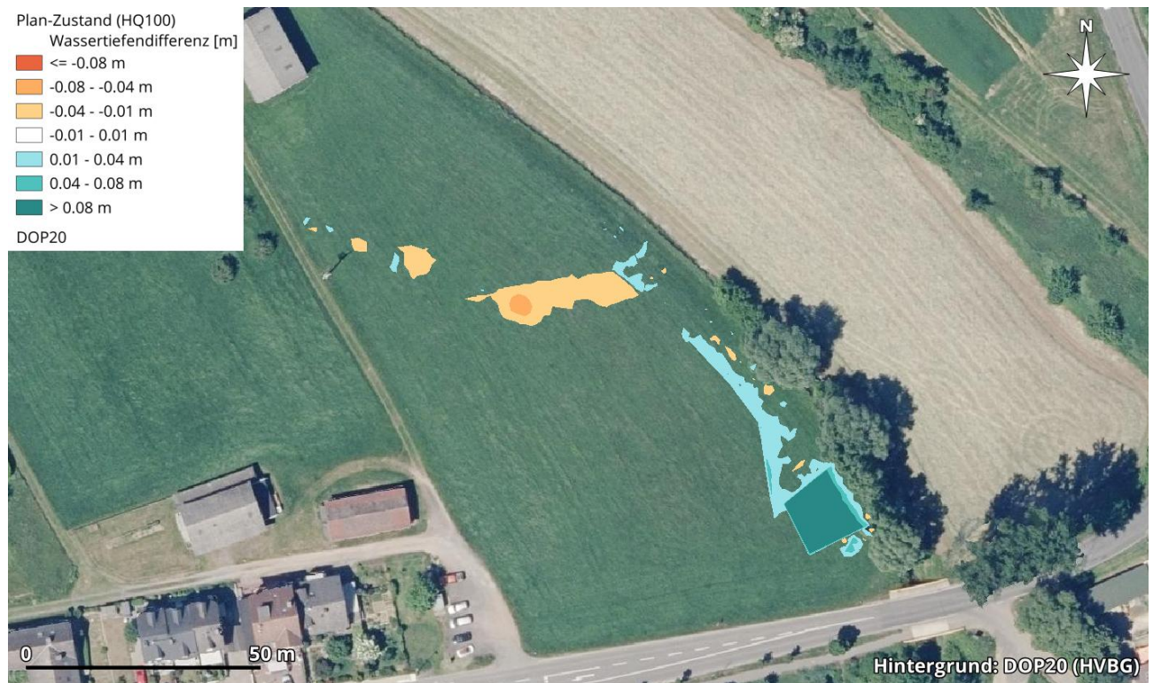
Abbildung 9: Wassertiefendifferenzen (Plan-Zustand minus Ist-Zustand) im Bereich des geplanten Feuerwehrgerätehauses bei HQ 100
