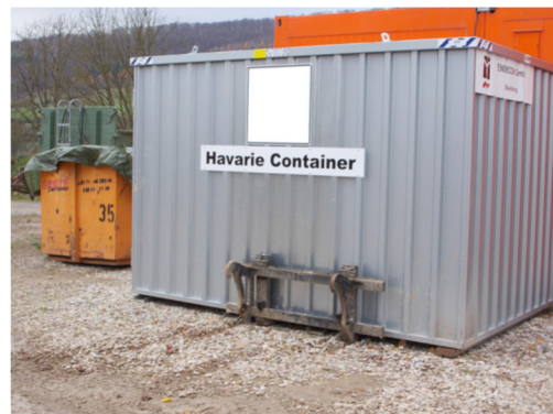
Abbildung 7: Mobiler Havarie Container - Beinhaltet Materialien zur Bekämpfung ausgetretener, wassergefährdender Stoffe
