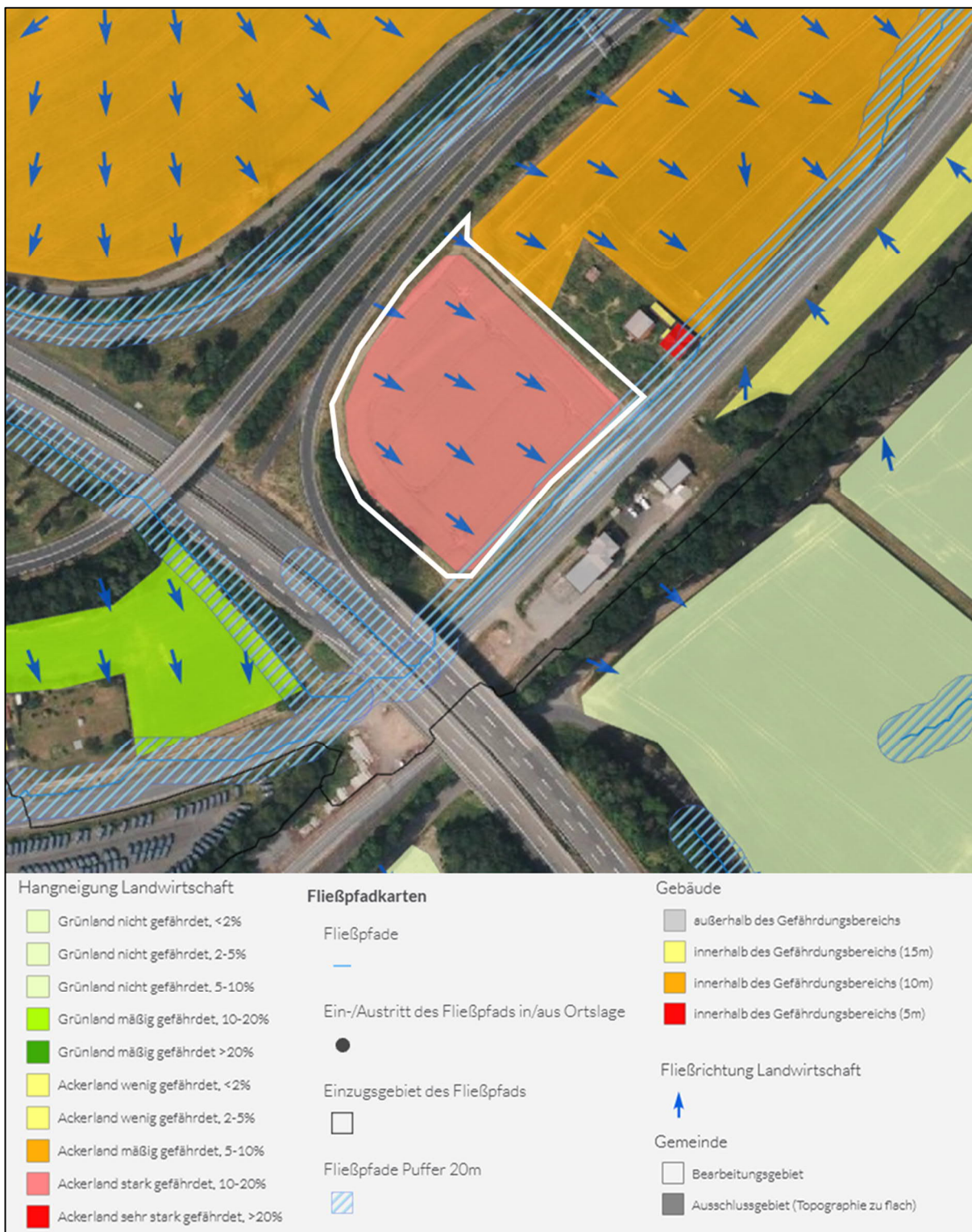
Abb. 5: Fließpfade im Bereich des Plangebietes (weiß umrandet; Quelle: StarkregenViewer Hessen (HLNUG), Zugriffsdatum: 23.03.2026, eigene Bearbeitung).
