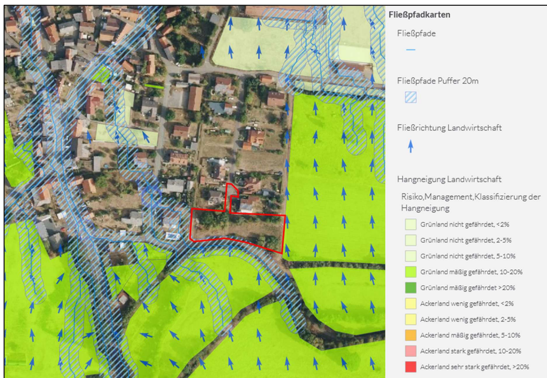
Abb. 5: Wasserabfluss und Fließpfade in der Umgebung des Plangebietes (rot umrandet) (Quelle: StarkregenViewer Hessen (HLNUG), Stand 07/2026, eigene Bearbeitung)
