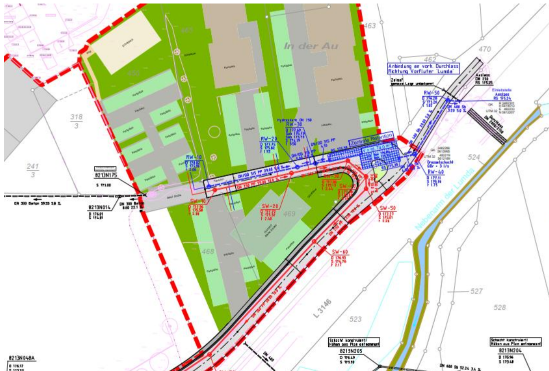
Abb. 18: Entwässerungsplanung HS Ingenieure
