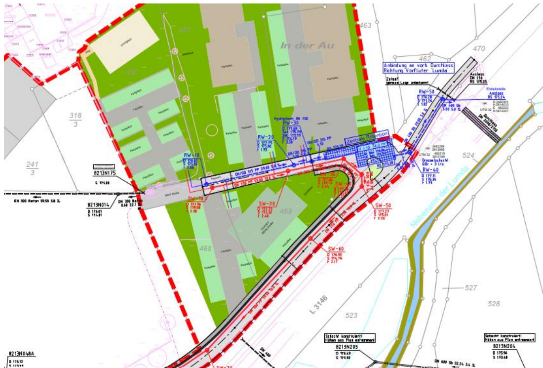
Abb. 17: Entwässerungsplanung HS Ingenieure
