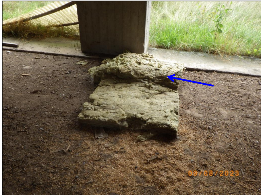
Foto 39 Werkstatt/Holzlager (37/15), KG: gelagerter KMF-Dämmung , exemplarisch
