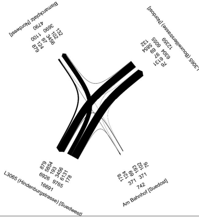
werktägliche Schwerverkehrbelastungen [Kfz<sub>sv</sub>/ 24h]: Tagesverkehr 00:00 – 24:00 Uhr
