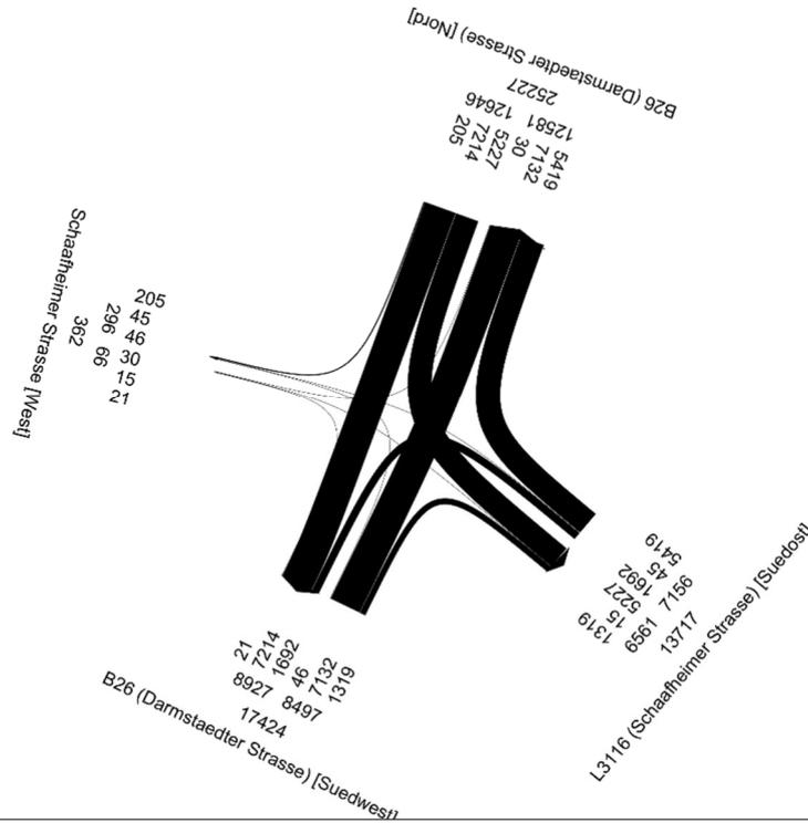
werktägliche Schwerverkehrbelastungen [Kfz<sub>sv</sub>/ 24h]: Tagesverkehr 00:00 – 24:00 Uhr
