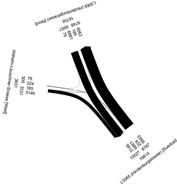
werktägliche Schwerverkehrbelastungen [Kfz<sub>sv</sub>/ 24h]: Tagesverkehr 00:00 – 24:00 Uhr
