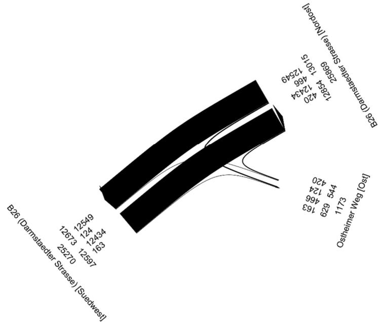
werktägliche Schwerverkehrbelastungen [Kfz<sub>sv</sub>/ 24h]: Tagesverkehr 00:00 – 24:00 Uhr
