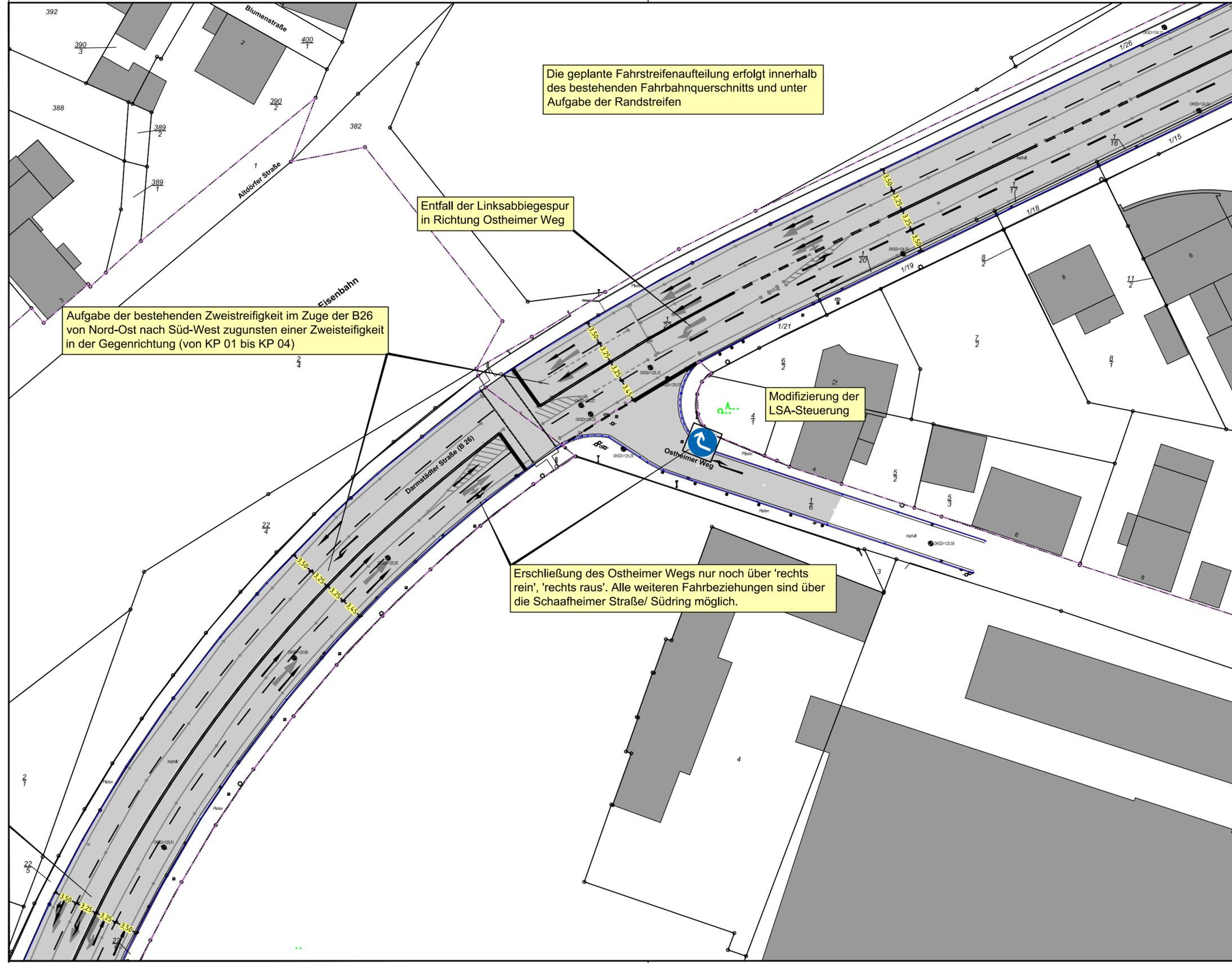
Die geplante Fahrstreifenaufteilung erfolgt innerhalb des bestehenden Fahrbahnquerschnitts und unter Aufgabe der Randstreifen
